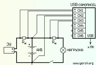
Имеет 6 гальванически изолированных каналов. Напряжение изоляции 400В.
